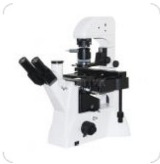
Микроскоп инвертированный Биоптик CI-400
